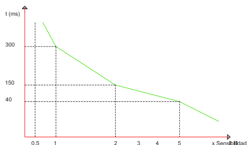
Figura A.55. Curva de disparo ( I\Delta n / t ) de un interruptor diferencial.
